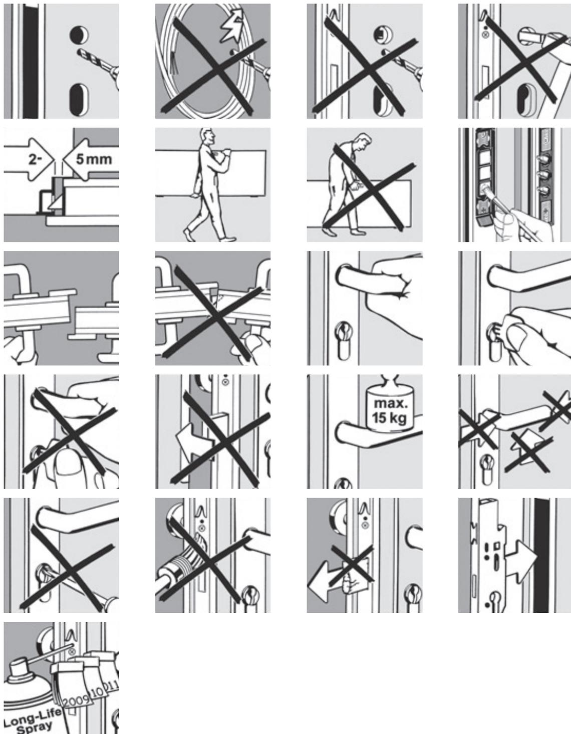
Almeno una volta all'anno verificare lo stato di usura e l'opportuno fissaggio della ferramenta rilevante ai fini della sicurezza. Se necessario incaricare una ditta specializzata di provvedere al serraggio delle viti di fissaggio ed alla sostituzione di eventuali parti danneggiate o usurate con parti di ricambio originali.
