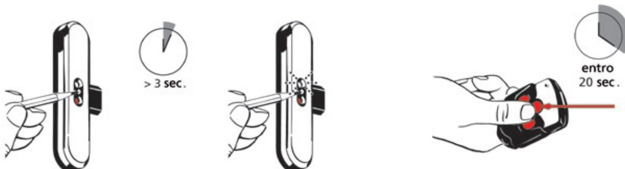
1. Chiudere l'anta della porta e premere **per più di 3 secondi** il tasto di programmazione posto fra il LED rosso e quello verde della centralina di controllo servendosi di un oggetto appuntito (per esempio una penna a sfera o una matita).
