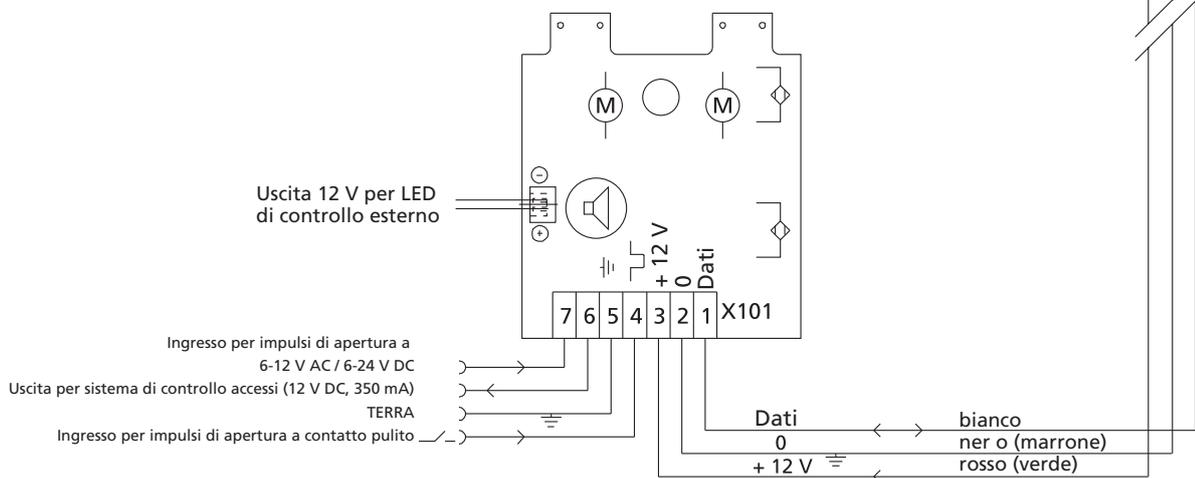
Funzione speciale "apriporta elettrico" della scheda di controllo 834 mediante rimozione del ponticello "DRT":
