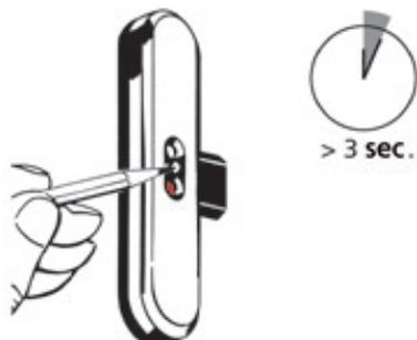
1. Chiudere l'anta della porta e premere **per più di 3 secondi** il tasto di programmazione posto fra il LED rosso e quello verde della centralina di controllo servendosi di un oggetto appuntito (per esempio una penna a sfera o una matita).
