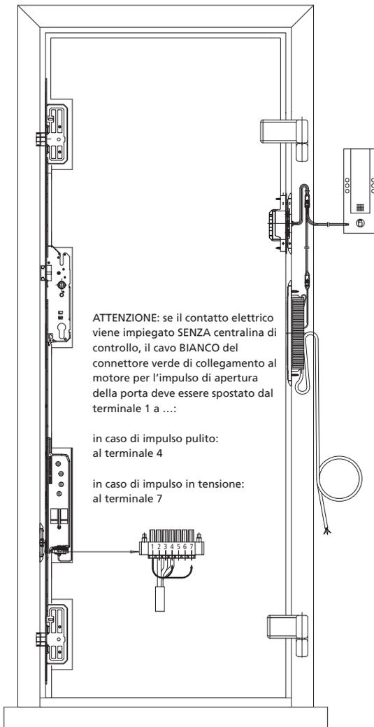
Impulso di apertura da citofono o sistema di controllo accessi:
