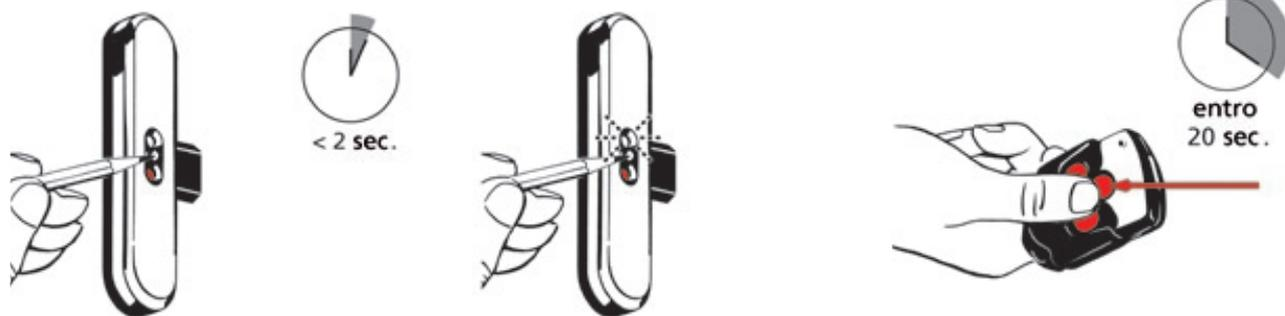
2. Chiudere l'anta della porta e premere **brevemente (meno di 2 sec.)** il tasto di programmazione posto fra il LED rosso e quello verde della centralina di controllo servendosi di un oggetto appuntito (per esempio una penna a sfera o una matita).
