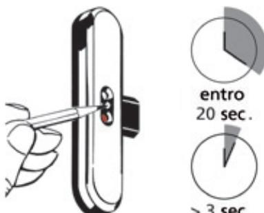
5. Quindi, **entro 20 secondi** premere il tasto di programmazione della centralina **per più di 3 secondi**. In caso di superamento del tempo massimo di 20 secondi la procedura di cancellazione viene interrotta.
